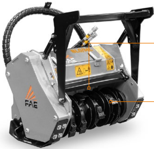
Rotore con tecnologia Bite Limiter massima produttività e minima richiesta di potenza grazie agli speciali inserti in acciaio altamente resistente e alle lame di tipo BL/MINI
