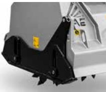
Slitta destra regolabile per il corretto allineamento della testata nelle sovrapposizioni
