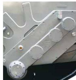
Doppia trasmissione ad ingranaggi diminuisce la velocità del rotore riducendo l'usura degli utensili
