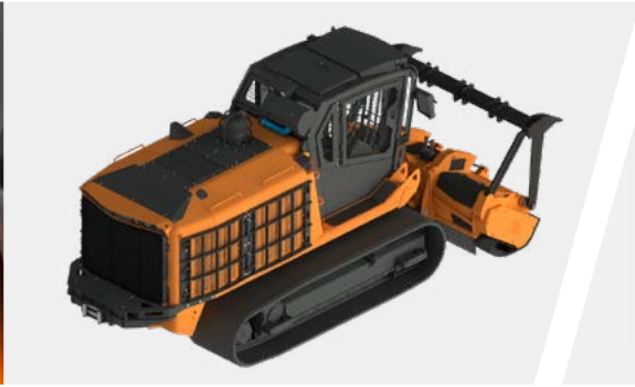
Kit protezioni forestali (griglie di protezione vetri laterali cabina + protezioni porte vano motore)
