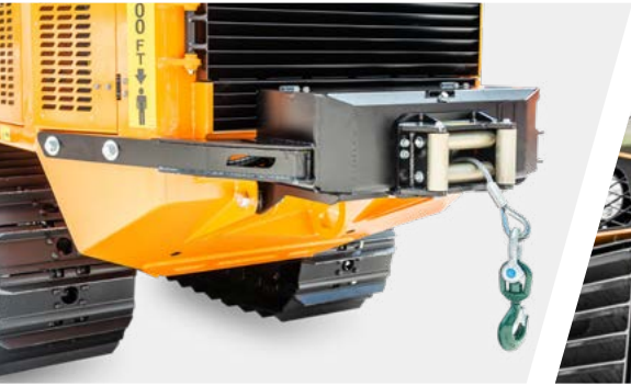
Verricello posteriore con forza di trazione 6 t
