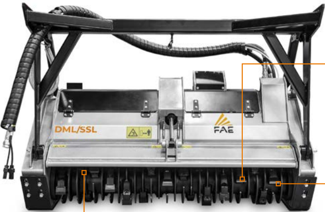
Controlame Spike PRO per una migliore finitura del materiale lavorato
