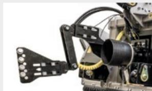
**Sistema di regolazione del parallelismo tipo W tra scatola ingranaggi-cardano** permette alla trincia di lavorare in più angolazioni senza danneggiare la presa di forza
