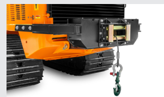
Verricello posteriore con capacità di traino di 6t
