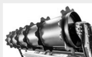
**Rullo d'appoggio regolabile idraulicamente (D. 36 cm - D. 51 cm)** con raschia rullo per permettere la pulizia del rullo stesso
