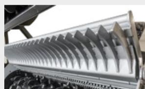
**Griglia avvitata sul cofano** permette la regolazione della granulometria del materiale in uscita
