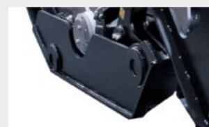
**Slitte a regolazione idraulica** permettono di regolare la profondità di lavoro del rotore ed evitano la fuoriuscita di materiale dai lati
