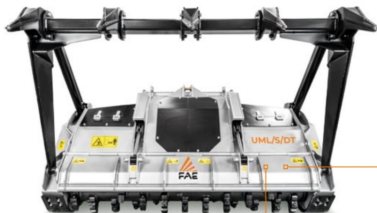
**Controlame avvitate intercambiabili Spike** con cui l'operatore può regolare la dimensione del materiale finale
