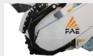
**Slitte a regolazione idraulica**
