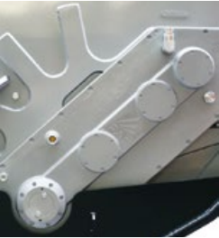
Doppia trasmissione ad ingranaggi diminuisce la velocità del rotore riducendo l'usura degli utensili
