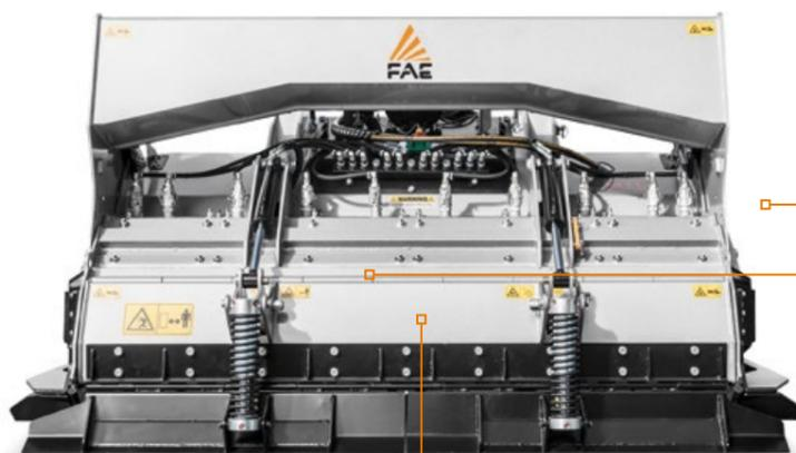
**Protezioni laterali** della fiancata interna del telaio facilmente sostituibili senza togliere il rotore: assicurano un'elevata resistenza all'usura, riducono i tempi di sostituzione
