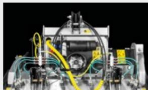
Il sistema **Water Spray System** (Basic & High Flow) ha duplice funzione di raffreddamento e miscelazione
