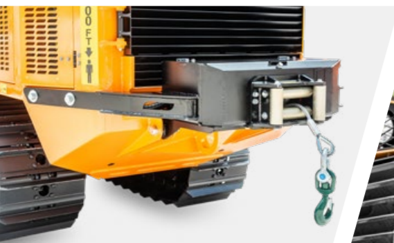
Verricello posteriore con capacità di traino di 6t
