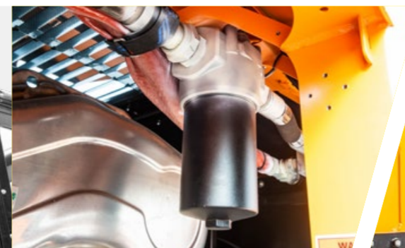
Filtro drenaggio (pacchetto filtrazione heavy duty)
