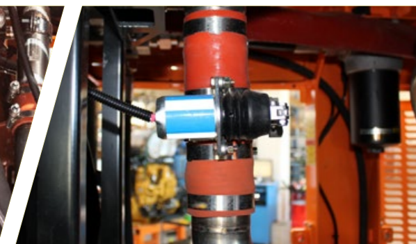
Sistema air shut-off
