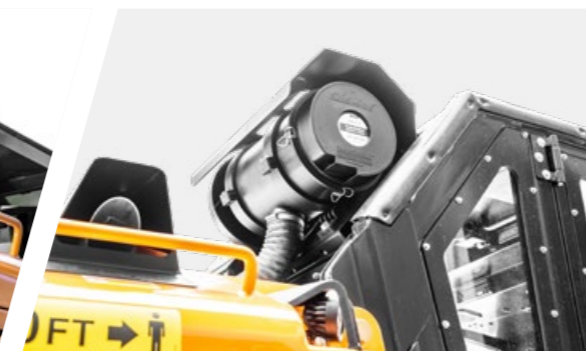
Sistema di pressurizzazione per la cabina
