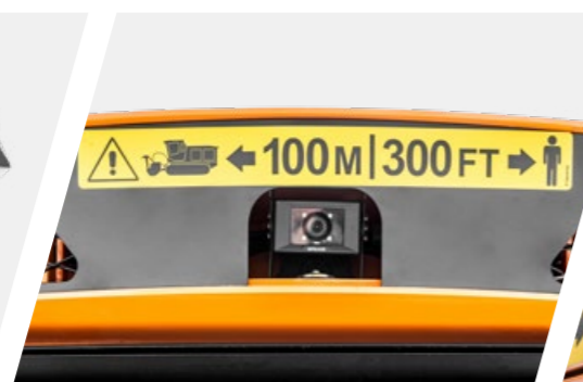
Telecamera posteriore con display LCD aggiuntivo (pacchetto visibility)
