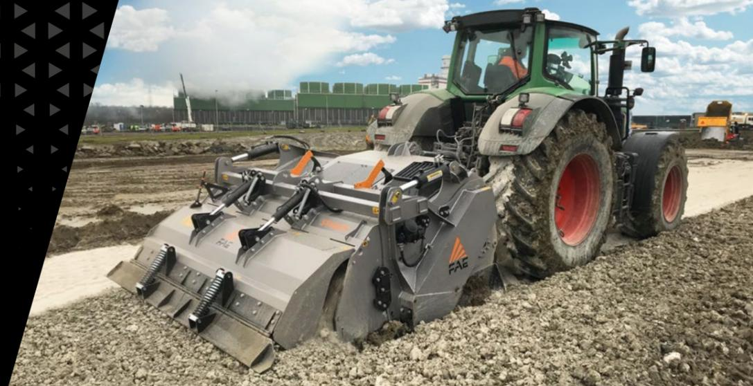
**Camera a geometria variabile** per lavorare il terreno con precisione ed ottenere una miscelazione ottimale
