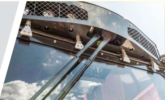
Système de nettoyage des vitres à air
