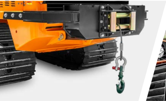
Treuil arrière, capacité 6 tonnes
