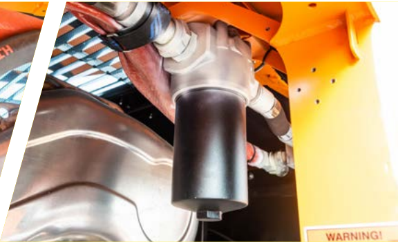
Système de filtration pour tâches exigeantes (drainages)
