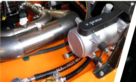
Système de préchauffage moteur et huile hydraulique
