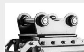
**Plaque d'attache avec axes**
