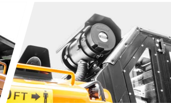
Système de pressurisation de la cabine
