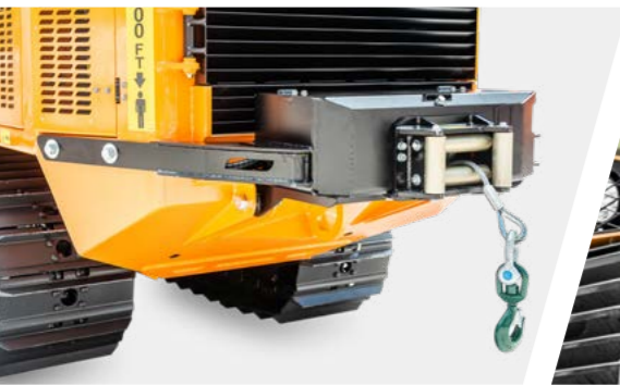
Treuil arrière, capacité 6 tonnes
