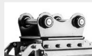
**Plaque d'attache avec axes**
