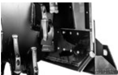
Pieces d'usure interchangeables entretien simple et rapide pour une efficacité améliorée
