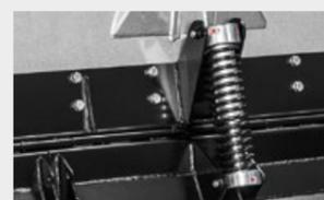
**Bandes de nivellement sur porte arrière amorties**
