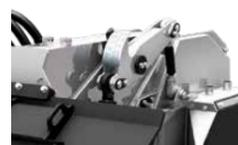
**Patins autonivelants** avec contrôle hydraulique de la profondeur
