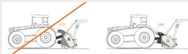
**Modèle indiqué pour les tracteurs avec prise de force abaissée**
