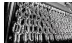
**Le nouveau système de protection par chaînes** sont des plaques fixées et celles-ci sont vissés au châssis
