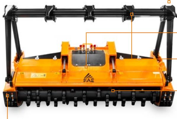
Rabatteur mécanique ou hydraulique (en option)
