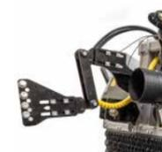
**1** **Système de réglage du parallélisme entre boîte d'engrenages-cardan type W** pour une durée de vie accrue des composants
