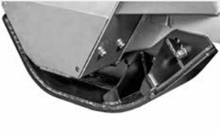
Patines especiales de penetración subterránea
