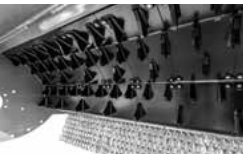
Cuchillas contra corte atornilladas intercambiables tamaño de producto final ajustable durante operación
