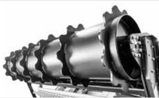
Rodillo de accionamiento hidráulico o rodillo hidráulico ancho (wide roller) con raspador para permitir al rodillo trabajar en suelos húmedos
