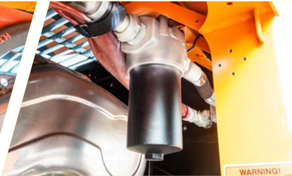
Sistema de filtración de trabajos pesados (drenaje)
