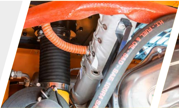
Sistema de filtración de trabajos pesados (eyector)
