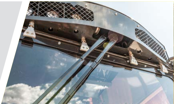
Sistema de aire para la limpieza de los cristales
