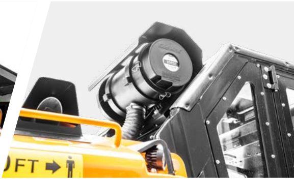
Sistema de presurización de la cabina
