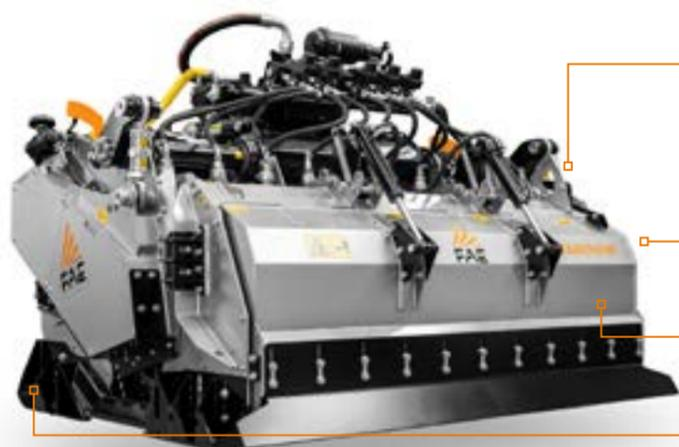
**Cámara de geometría variable** para trabajar el terreno con precisión y lograr una mezcla óptima
