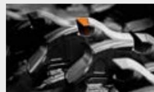
**Amplio surtido de dientes especiales**, eatornillados con plaquitas de Widia® antidesgaste, intercambiables y adecuados para diferentes aplicaciones
