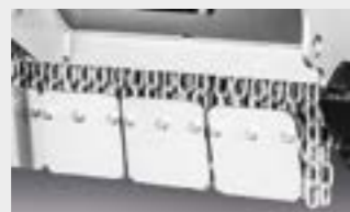
Láminas con cadenas de protección atornilladas
