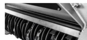
**Deflector trasero ajustable** permite una salida controlada del material triturado, aumentando los requisitos de seguridad
