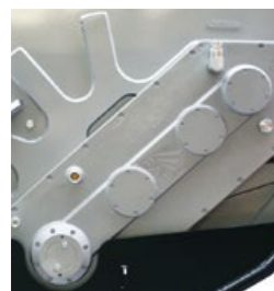
Doble transmisión lateral de engranajes para desacelerar el rotor, por ende reducir desgaste de dientes
