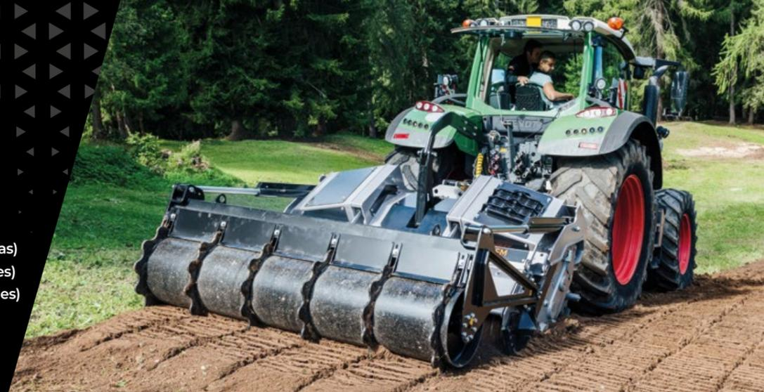
**Sistema autoajustable del eje de toma de fuerza PTO/transmisión tipo Z** manteniendo siempre el ángulo correcto de operación entre el eje PTO y el toma de fuerza
