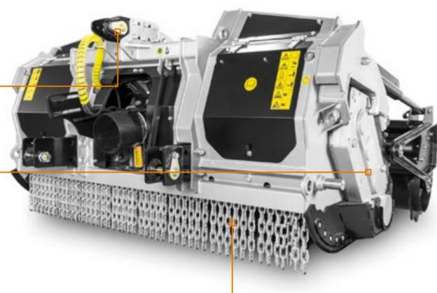
**Transmisión lateral de engranajes** para desacelerar el rotor, por ende reducir desgaste de dientes
