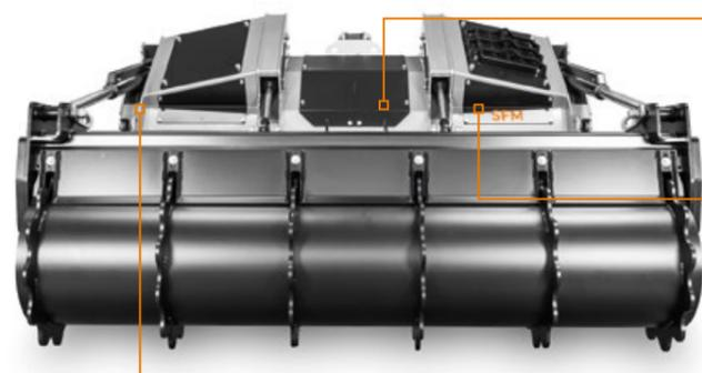
**Compuerta de trituración posterior hidráulica** para ajustar el tamaño de grano efectivamente
