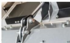
**Cuchillas contra corte de acero forjado y endurecidas con tratamiento térmico intercambiables** para mayor durabilidad
