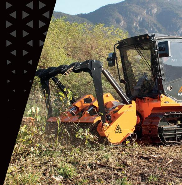
Estructura de empuje mecánica o hidráulica (opcional)
