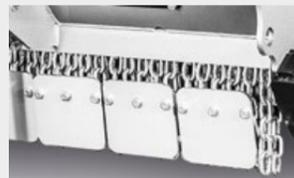
**Láminas con cadenas de protección atornilladas**
