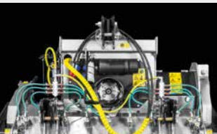
Sistema de inyección de agua WSS Basic para reducir el polvo y para enfriar los dientes
