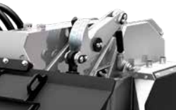
Indicador de profundidad para un control preciso de la elaboración
