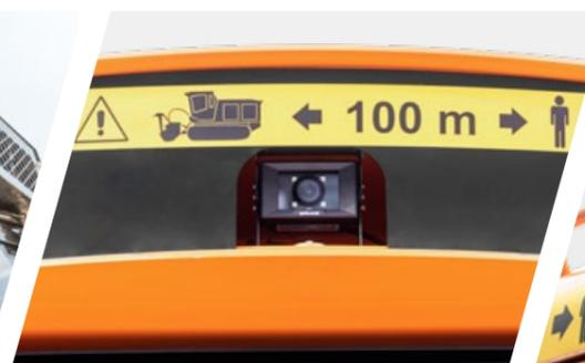
Videocámara trasera con pantalla LCD adicional (paquete visibility)
