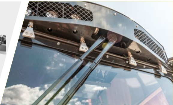
Sistema de limpieza de los cristales por aire
