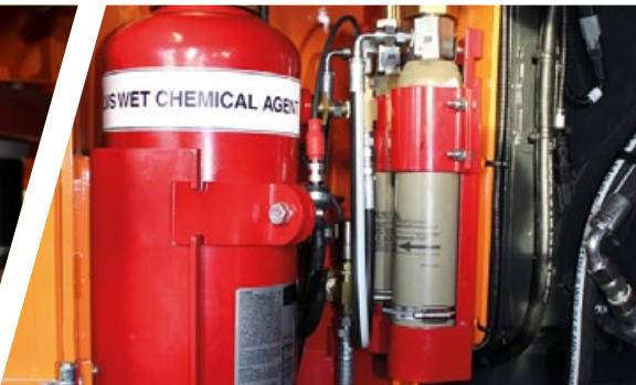
Sistema antiincendio automático
