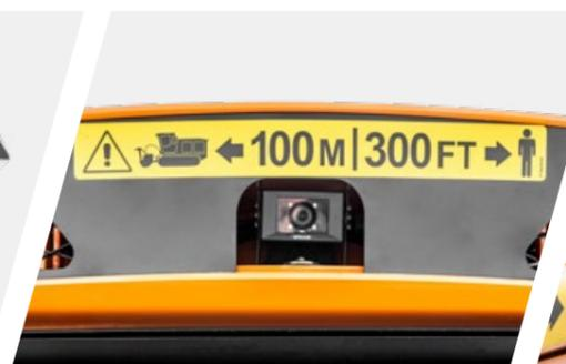
Videocámara trasera con pantalla LCD adicional (paquete visibility)
