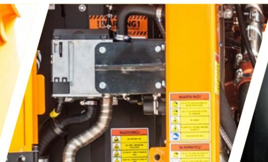
Sistema de precalentamiento para motor y aceite hidráulico
