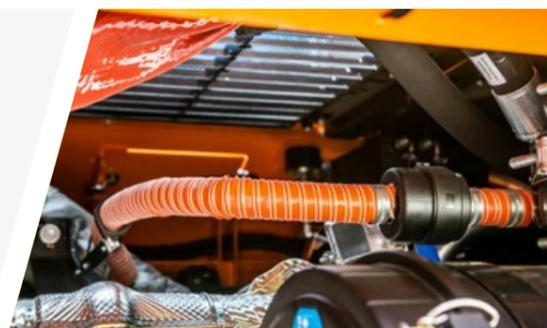
Eyector (paquete de filtración heavy duty)
