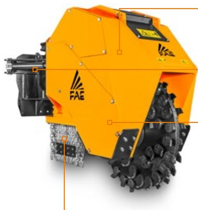
Cadenas de protección intercambiables con placas atornilladas
