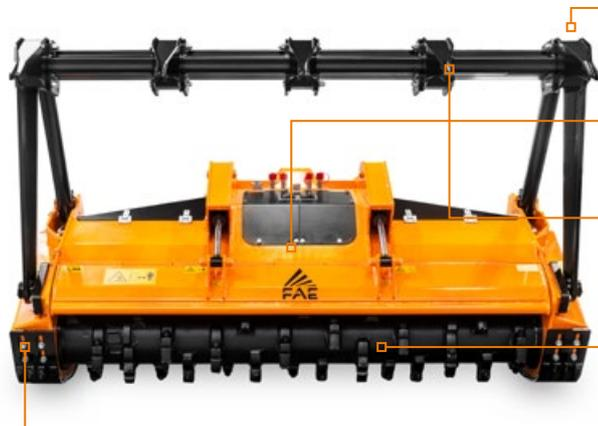
Estructura de empuje mecánica o hidráulica (opcional)
