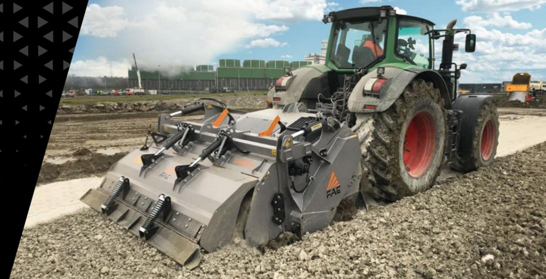
**Cámara de geometría variable** para trabajar el terreno con precisión y obtener un mezclado ideal
