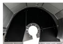
**Protecciones internas y laterales de Hardox** intercambiables
