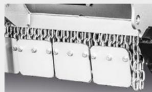
**Láminas con cadenas de protección atornilladas**
