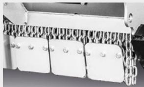
Láminas con cadenas de protección atornilladas
