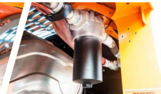
Filtro de drenaje (paquete de filtración heavy duty)
