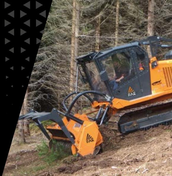
Estructura de empuje mecánica o hidráulica (opcional)
