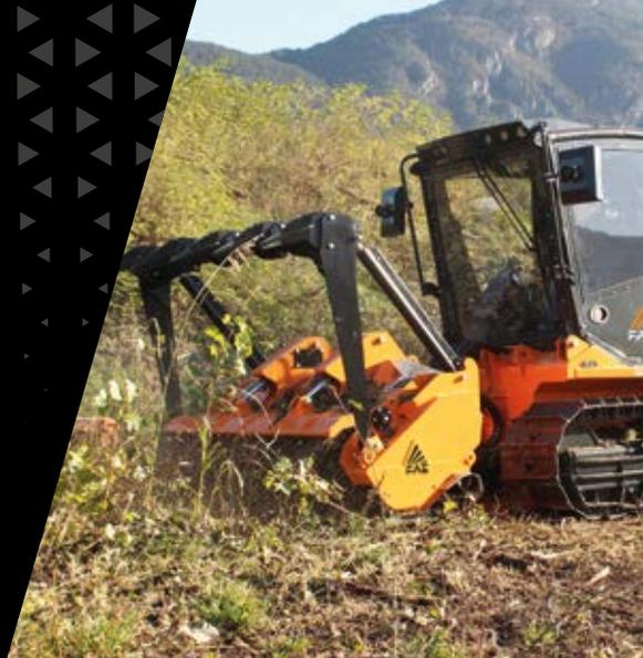
Estructura de empuje mecánica o hidráulica (opcional)
