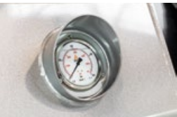
Manometer zur Kontrolle des Betriebsdrucks
