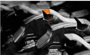
Möglichkeit, den Rotor mit verschiedenen Fräsmeißeln auszustatten
